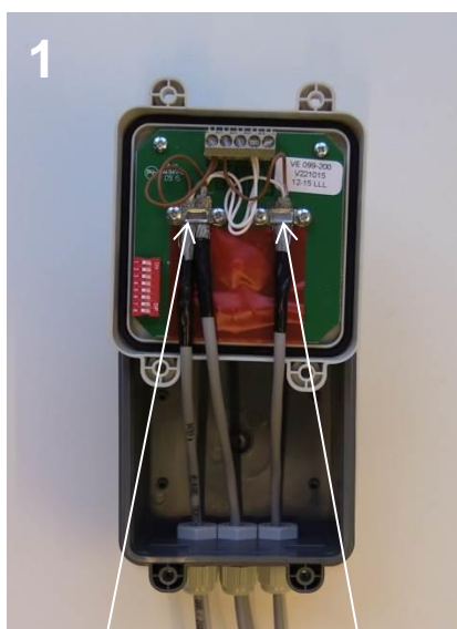
1 BUS kabler forbundet til to LISA 2 basic sæt BUS kabel forbundet til LISA 2 start up sæt
