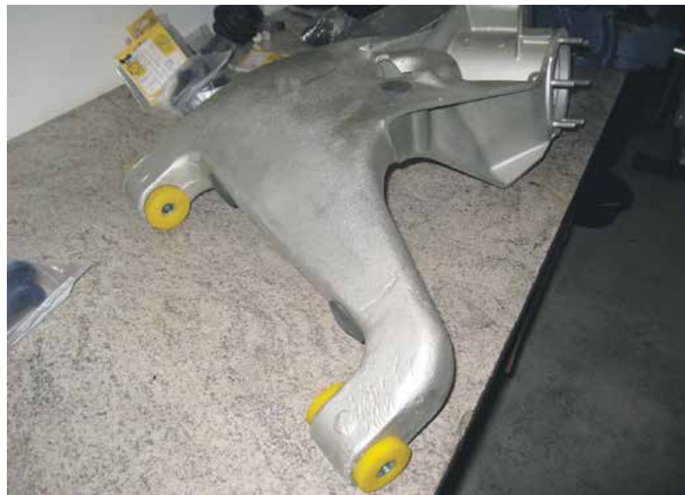
Næste vinter var det baghjulene, som fik en tur. Der monteres poly-bøsninger i alle bevægelige dele.
