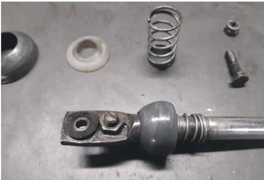
Nylonskiverne er placeret i de to led på skiftestangen.
