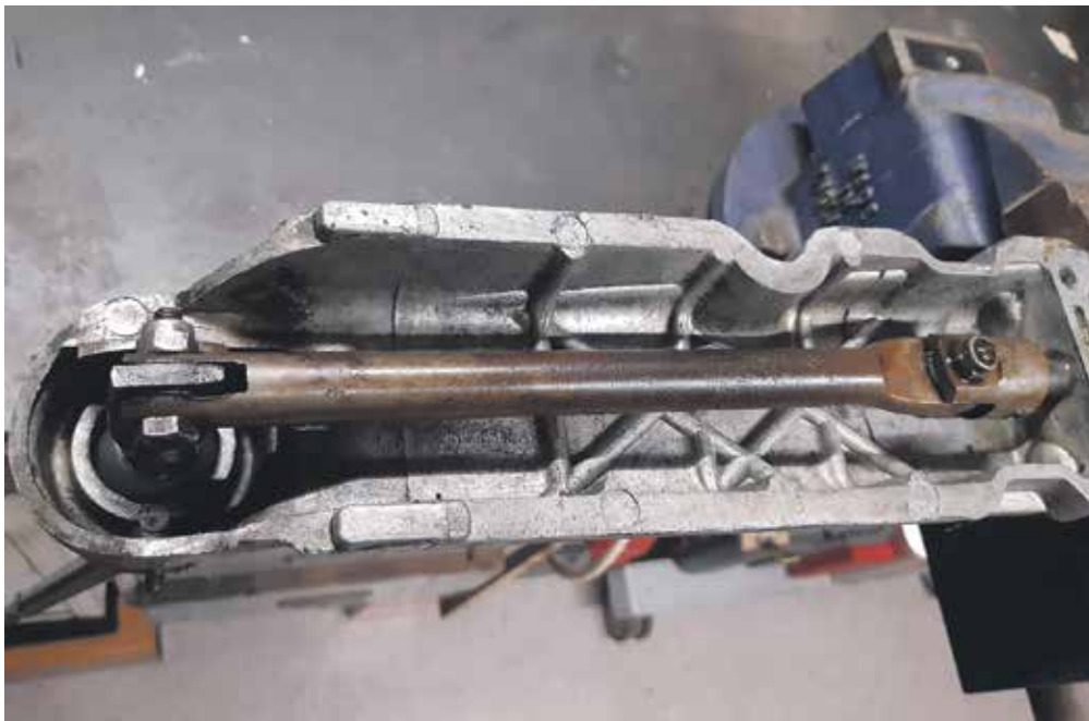
Nylonskiverne er placeret i de to led på skiftestangen.
