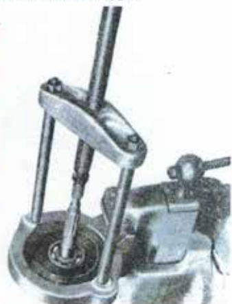
CLS4221A drar ut oljekastarbricks och kullagar från hastighetsmätardrevet i växellådan. Mångsidigt verktyg.
