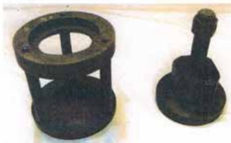
Till v8: 7 Till h8: "Rear hub pulley" CLS1096. Till Herald, Vitesse, Spitfire, GT6. Demontering av baknav och bromstrumma.
