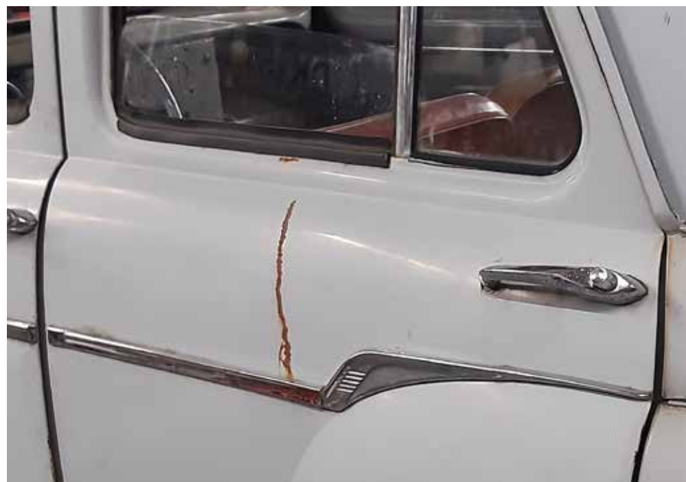
Reparation af lakskade på bagdør
