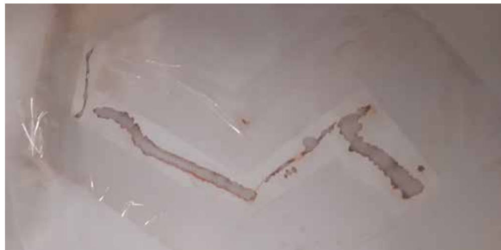
Reparation af lakskade på fronthjelm
