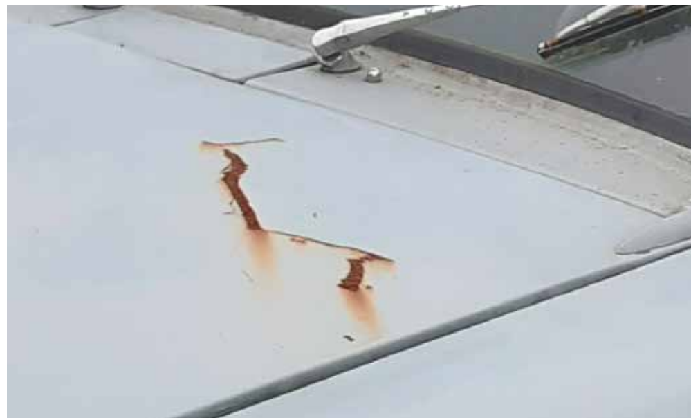
Reparation af lakskade på fronthjelm
