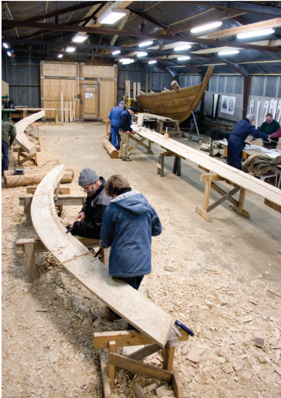
Værftet er så rummeligt, at vi kan arbejde på begge sider af båden med tildannelse af bordplanker. På siden med vinduer bliver der plads til en arbejdslinie mere til årer, kejer og apteringsdele (tofte, dørk, spanter mm).
